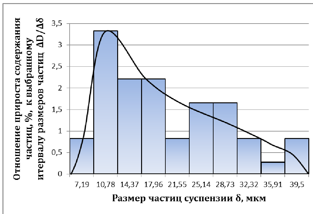
Рис. 6. Дифференциальная кривая распределения фракций суспензии кальция гопантената в холина альфосцерате дополнительную стабильность. При механическом воздействии структурные связи быстро разрушаются и также быстро восстанавливаются, обеспечивая текучесть суспензии в процессе капсулирования. Наилучшими реологическими характеристиками при температурах от 25,0 °С до 45,0 °С обладал состав № 3, содержащий кальция гопантенат в количестве 22,5 % (рис. 7).
