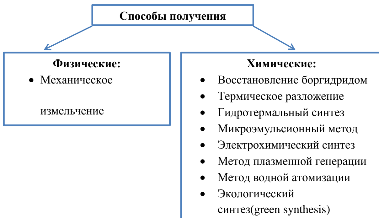
Рисунок 5 – Способы получения микро- и наночастиц \text{Fe}(0)
