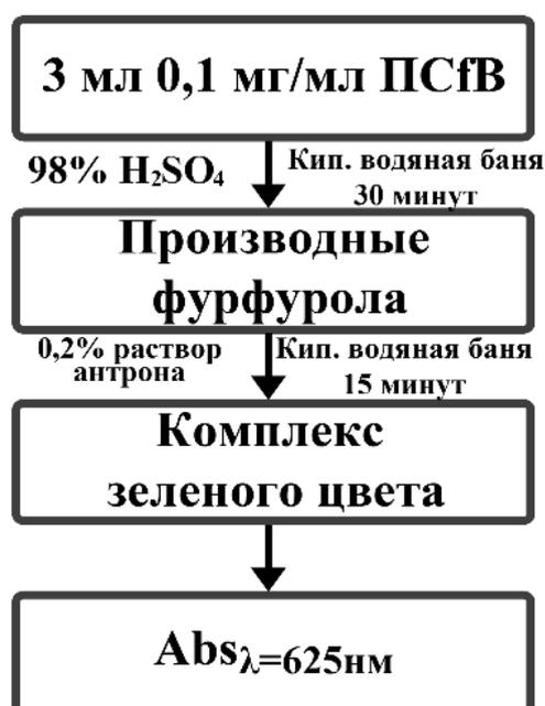
Рисунок 18 – Блок-схема разработанной методики количественного определения ПСfВ.
