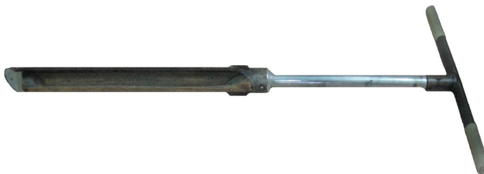
Рисунок 2.2.1 – Торфяной пробоотборочный бур ТБГ-1
