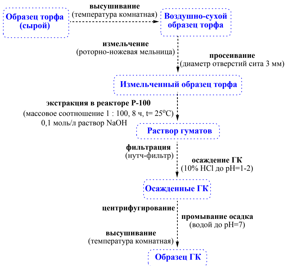
Рисунок 2.2.2 - Общая схема выделения гуминовых кислот из торфа [51]
