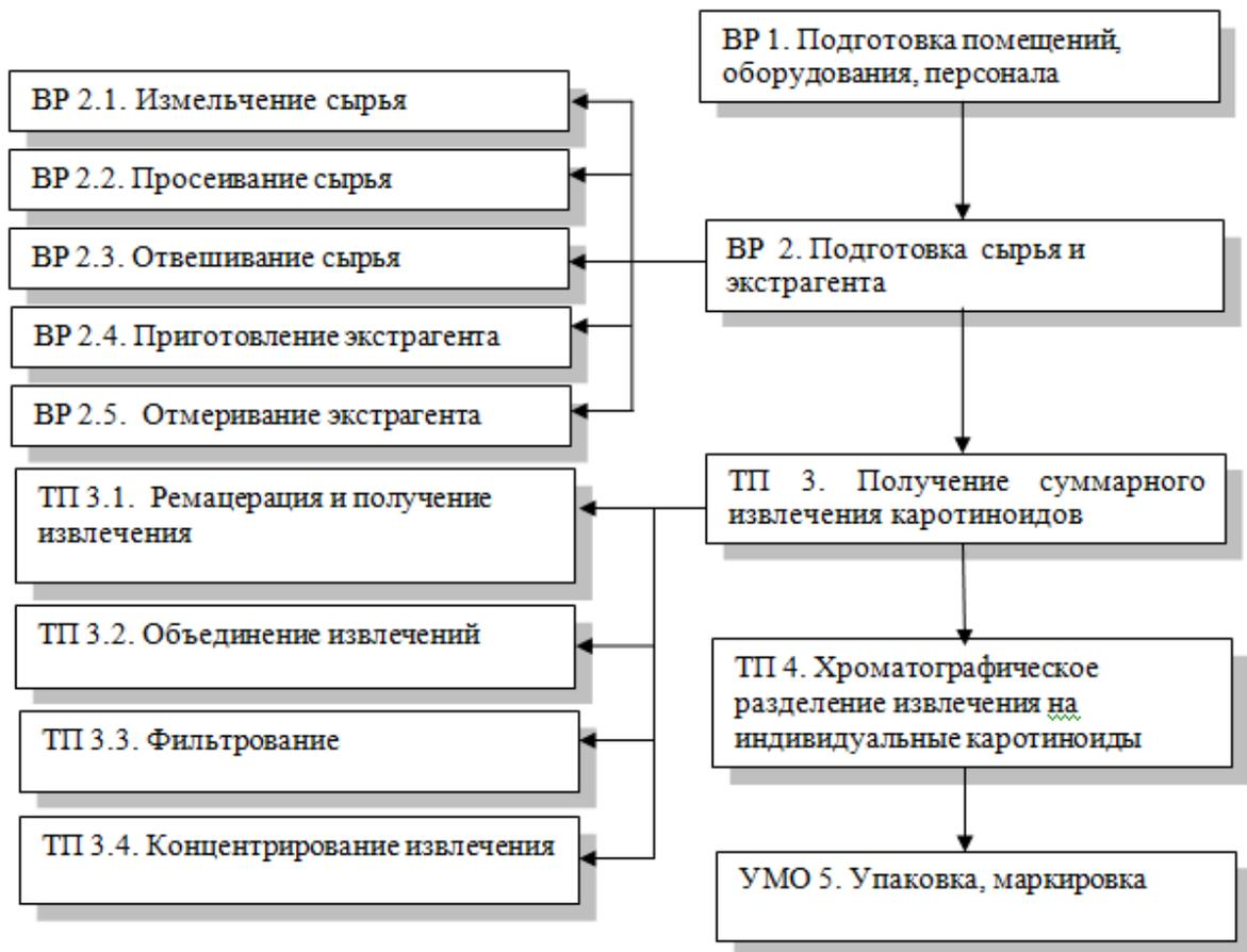
Рисунок 3.7 – Унифицированная технологическая схема получения индивидуальных каротиноидов
