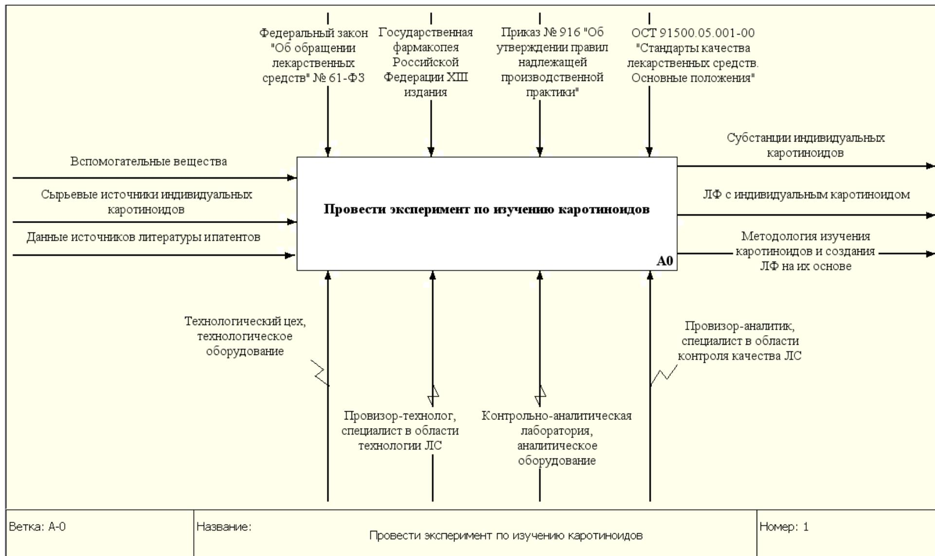
Рисунок 2.3 – Контекстная диаграмма модели IDEF0 экспериментального модуля исследования
