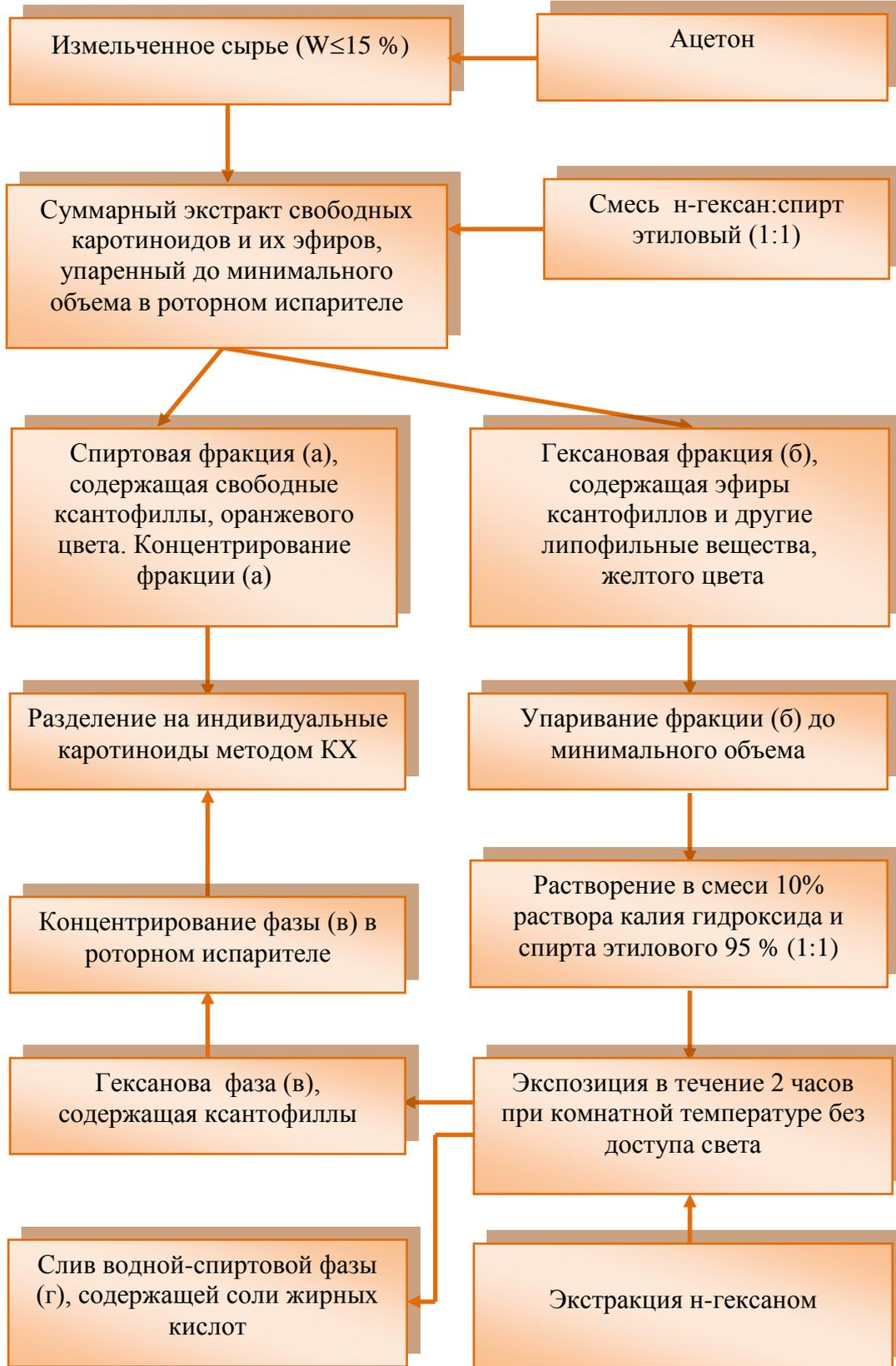
Рисунок 3.22 – Общая технологическая схема получения ксантофиллов из сырья животного происхождения
