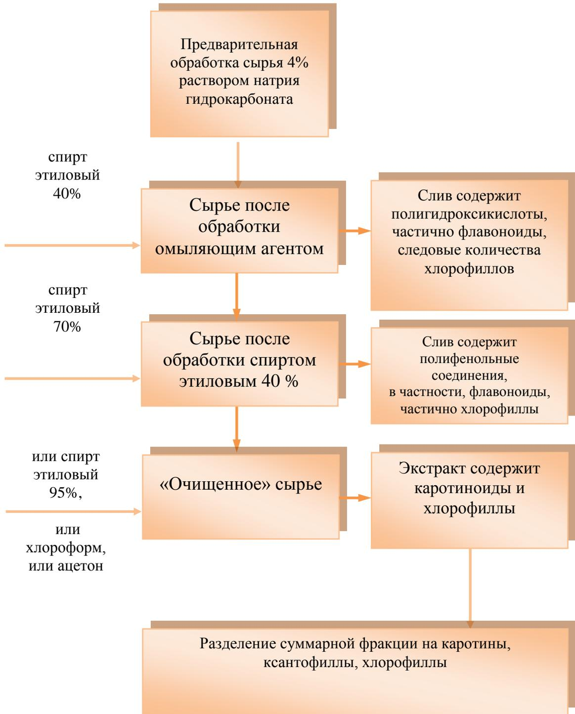
Рисунок 3.16 – Окончательная схема получения модельного суммарного экстракта хлорофиллов и каротиноидов
