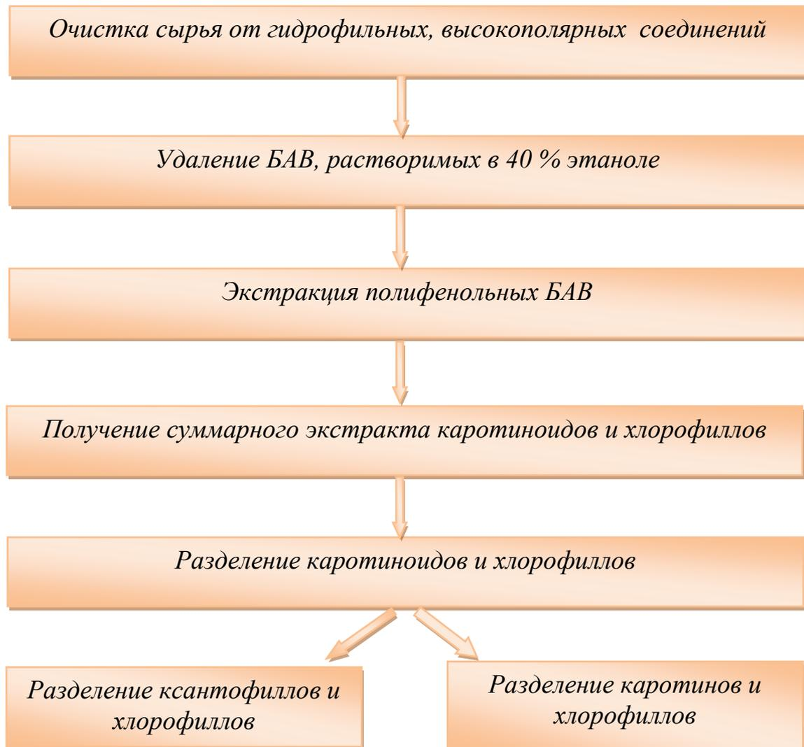
Рисунок 3.8 – Алгоритм разделения каротинов, ксантофиллов и хлорофиллов
