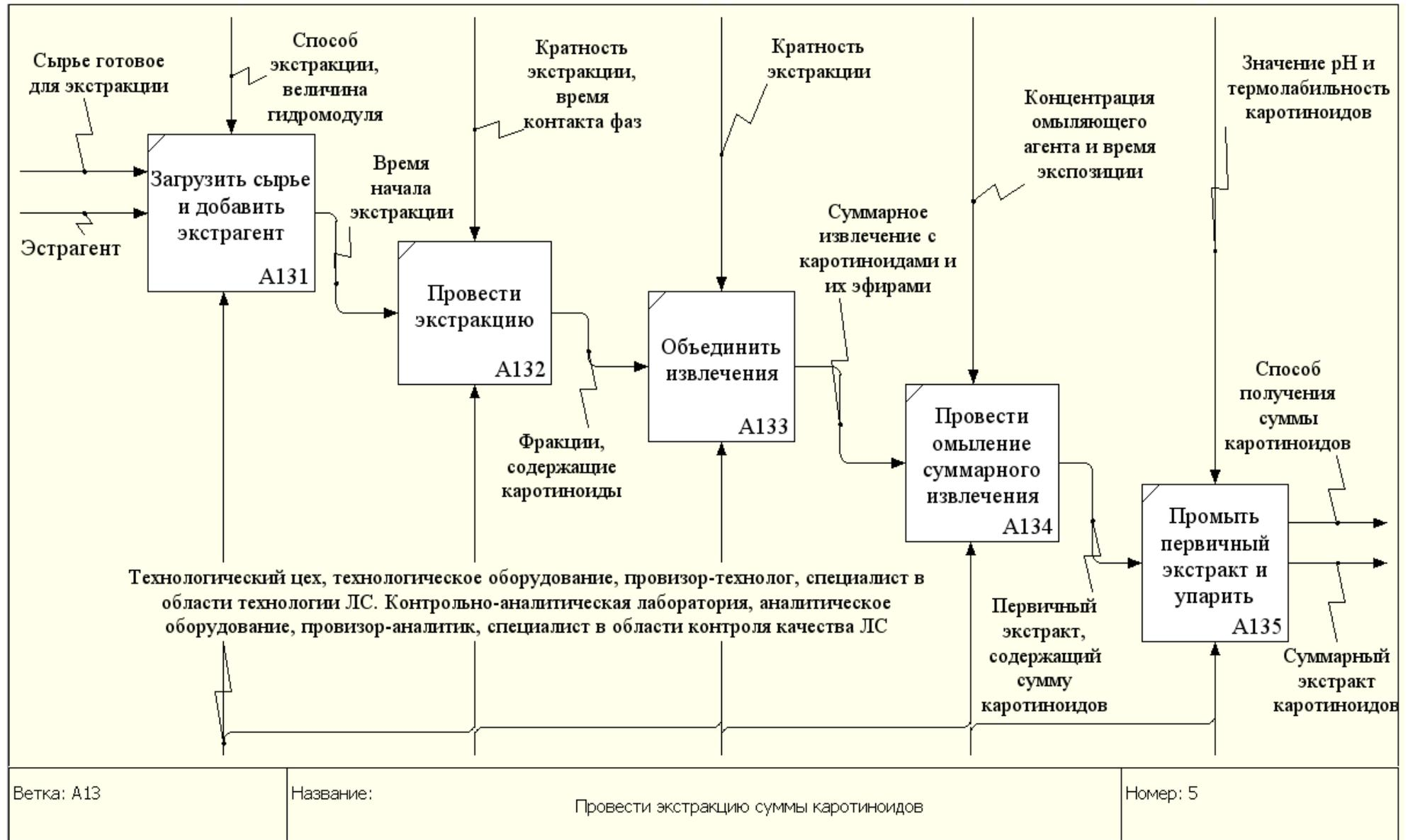
Рисунок 7.5 – Детализация третьего уровня блока А13 «Провести экстракцию суммы каротиноидов»
