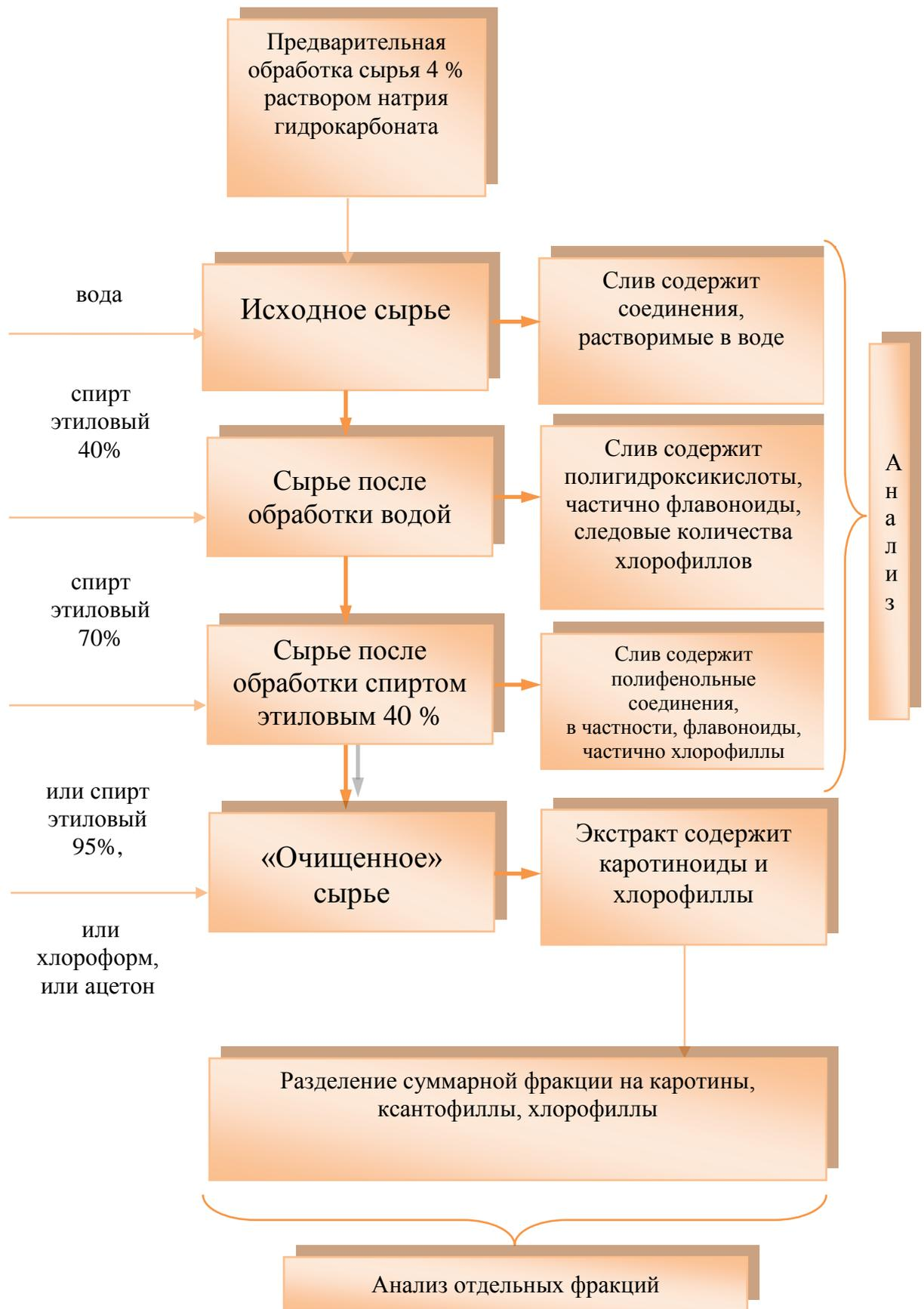
Рисунок 3.9 – Схема получения суммарной фракции, содержащей каротиноиды и хлорофиллы
