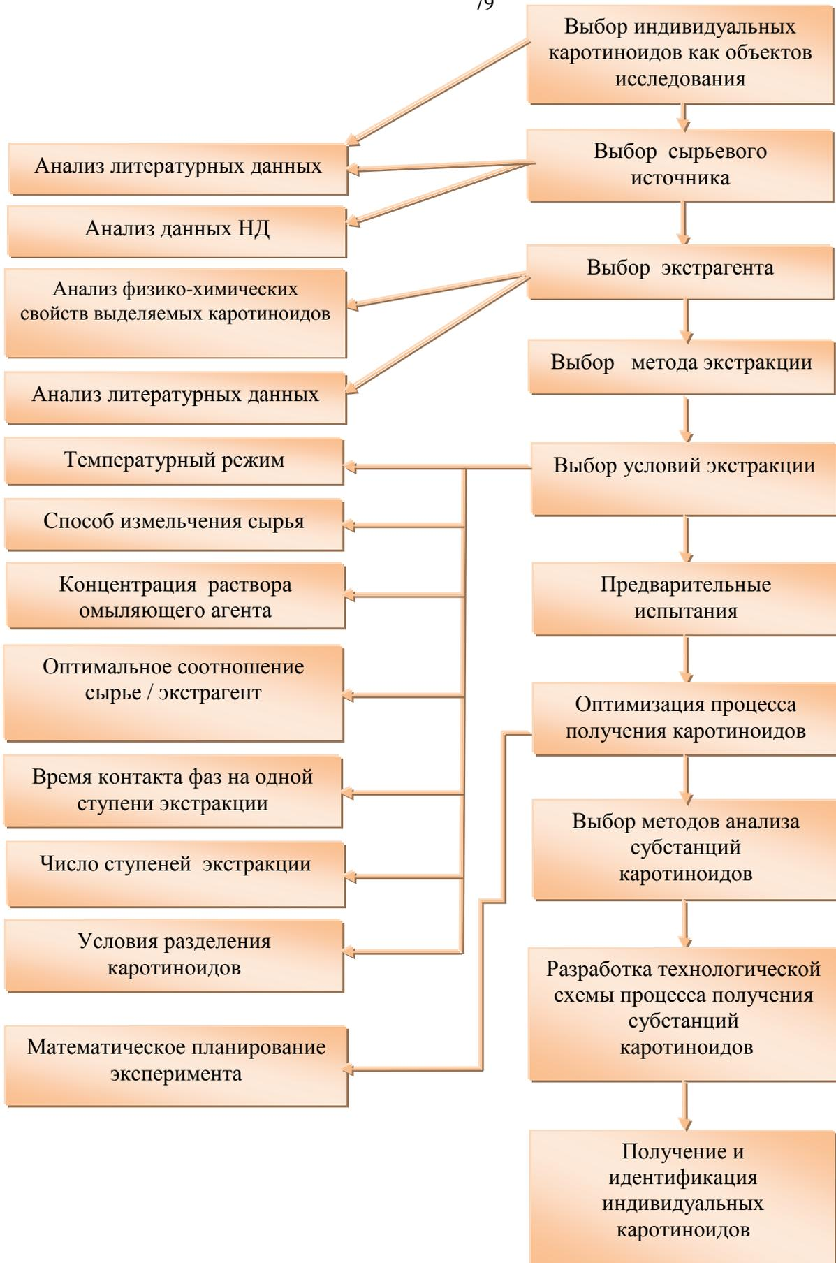
Рисунок 3.1 – Алгоритм разработки технологии получения субстанций каротиноидов
