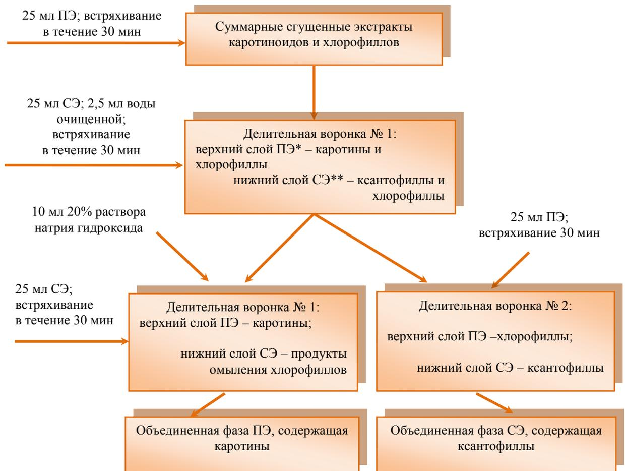
Рисунок 7 – Схема разделения каротинов, ксантофиллов и хлорофиллов (\*ПЭ – петролейный эфир, \*\*СЭ – спирт этиловый)
