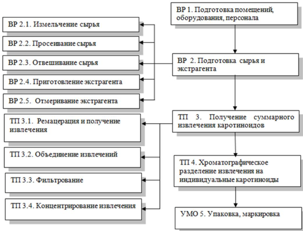
Рисунок 5 – Унифицированная технологическая схема получения индивидуальных каротиноидов
