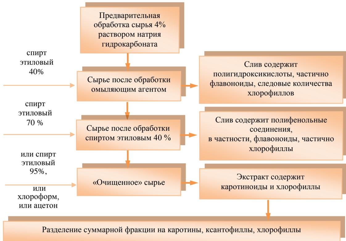
Рисунок 6 – Окончательная схема получения суммарной фракции, содержащей каротиноиды и хлорофиллы
