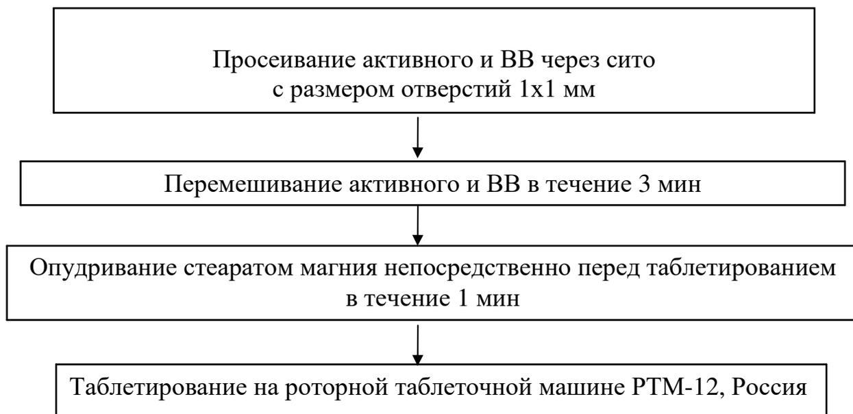
Рисунок 5 – Последовательность технологических операций производства таблеток-ядер рабепразола, изготовленных методом прямого прессования
