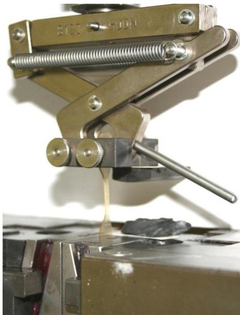
Рис.16. Образец желатина при установке в захваты
