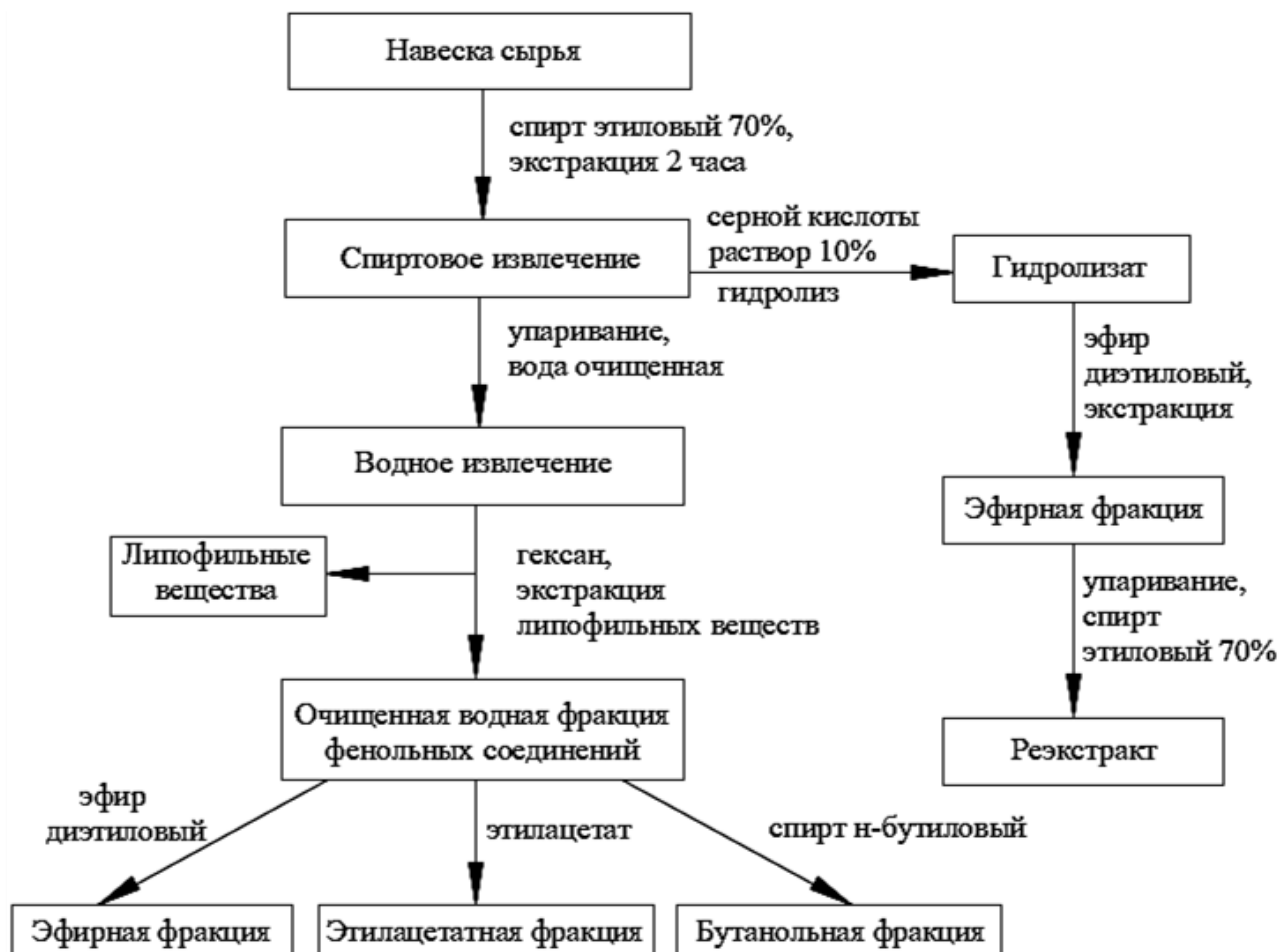
Рисунок 3 – Схема разделения фенольных соединений хатмы тюрингенской травы на фракции
