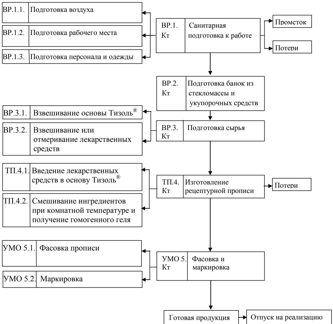
**Рисунок 25 - Общая технологическая схема классического изготовления рецептурных прописей на основе Тизоля®**
