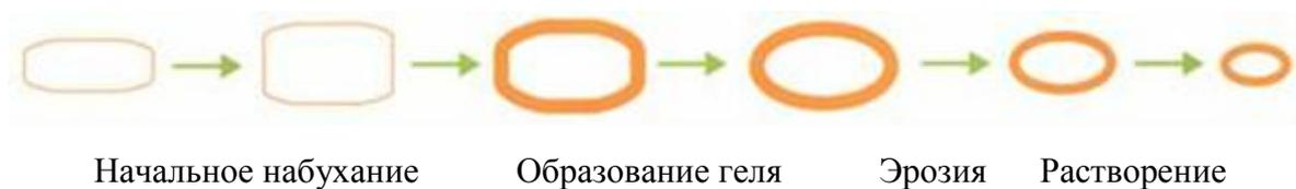
Рисунок 3.3. Механизм дезинтеграции таблеток матричного типа с гипромеллозой
