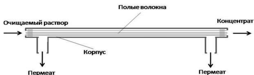
Рисунок 5 – Принципиальная схема строения половолоконного разделительного аппарата
