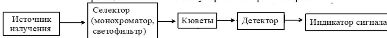
В зависимости от исследуемой области спектра используют разные источники, селекторы и детекторы.
