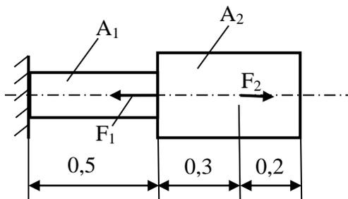
К стержню приложены силы  $F_1 = 20$  кН и  $F_2 = 15$  кН. Площади сечений  $A_1 = 100$  мм<sup>2</sup> и  $A_2 = 200$  мм<sup>2</sup>. Определить внутренние усилия и нормальные напряжения, возникающие в стержне вычислить общее удлинение стержня.
