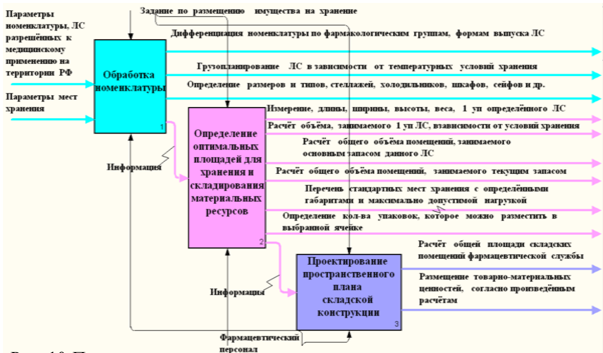
Рис. 10-Процедуры, составляющие процесс размещения лекарственных средств в нотации IDEF0
